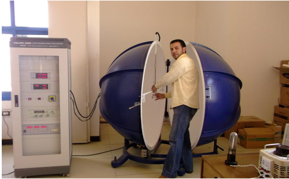
صورة توضح جهاز الاختبار الضوئي لجميع أنواع اللمبات بقدراتها المختلفة
